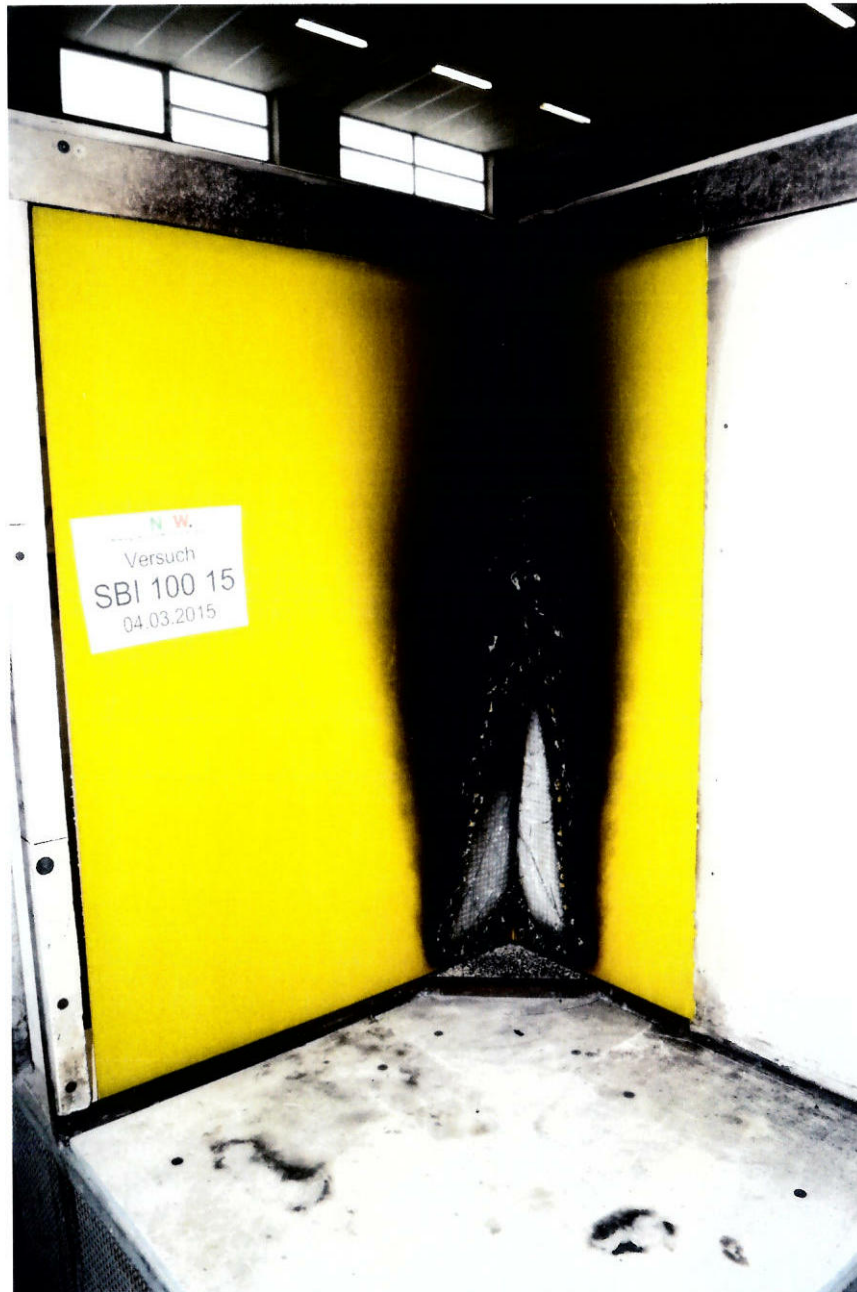
Aussehen des eingebauten Probekörpers A nach dem Versuch
